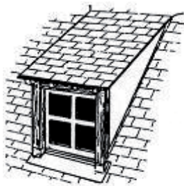
lucarne rampante ou en chien couché
